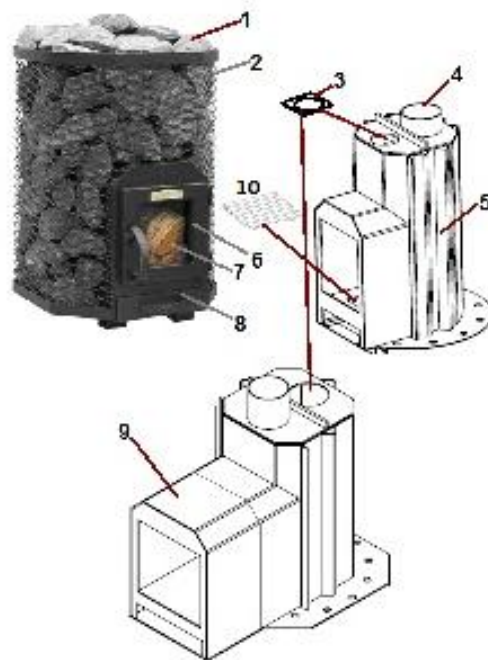
Rysunek 1. Elementy pieca do sauny
