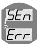
SEn Err (Sensor Error) elemento del espacio de piedras desconectado o dañado.
