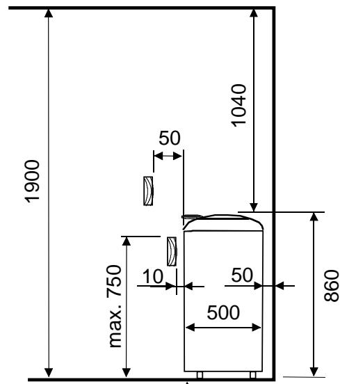
**Installation av styrpanelen**
