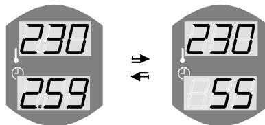
Den alsternerande visningen av badtiden och temperaturen i bastuuutrymmet i den nedre displayen, när sensor OLET 19 (tilläggsutrustining) har installerats i bastuuutrymme
