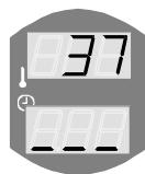
Температура отсека для камней гораздо ниже установленной температуры
