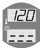
Температура отсека для камней составляет половину от заданной температуры
