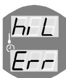
hiL Err (High Limit Error) – kivitila ylikuumentunut (>400°C), elektroninen katkaisu.
