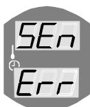
SEn Err (Sensor Error) – kivitilan termopari poikki tai vioittunut.
