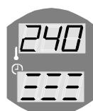
Kivistilan lämpötila saavuttanut asetetun lämpötilan
