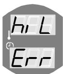
hiL Err (High Limit Error) espacio de piedras sobrecalegado ( $> 400^{\circ}\text{C}$ ), desconexión eléctrica.
