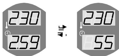
Нижний дисплей попеременно показывает оставшееся время работы печи и температуры в сауне при подключении датчика OLET 19 (приобретается отдельно)
