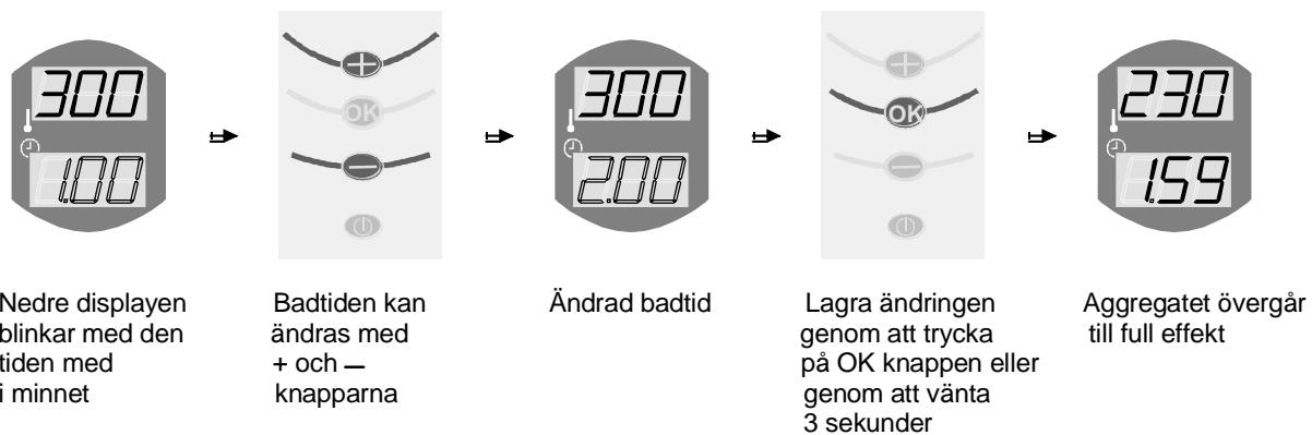
Därefter övergår bastuaggregatet till full effekt under önskad tid. Om det finns en sensor, som kan beställas som tilläggsutrustning, installerad i bastuuutrymmet, visar den nedre displayen alsternerande den återstående badtiden och temperaturen i bastuuutrymmet. Den övre displayen visar temperaturen i stenmagasinet.
