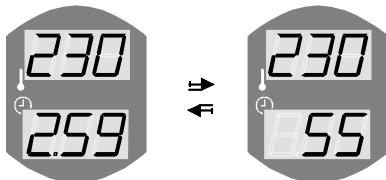
Alternancia del periodo de uso de la sauna y su temperatura en la pantalla inferior cuando el sensor OLET 19 (accesorio) está instalado en la sauna.
