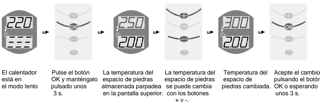
Después, la pantalla inferior muestra el último tiempo de sauna ajustado mientras parpadea. El tiempo de uso de la sauna también se puede controlar utilizando los botones + y - siempre que la pantalla parpadee. Puede estar entre 0 y 2 horas. El ajuste se almacena igual que la temperatura: o bien pulsando el botón OK, o bien esperando unos 3 segundos.
