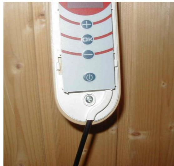
Прорежьте пластиковую заглушку у торца декоративной накладки для выхода кабеля.
