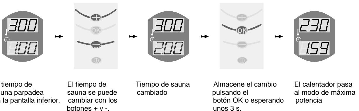
Entonces el calentador pasa al modo de máxima potencia durante el periodo deseado. Si se ha instalado un sensor OLET 19, disponible como accesorio, en el espacio de sauna, el tiempo de uso de la sauna y su temperatura se muestran alternativamente en la pantalla inferior. La pantalla superior muestra la temperatura del espacio de piedras.
