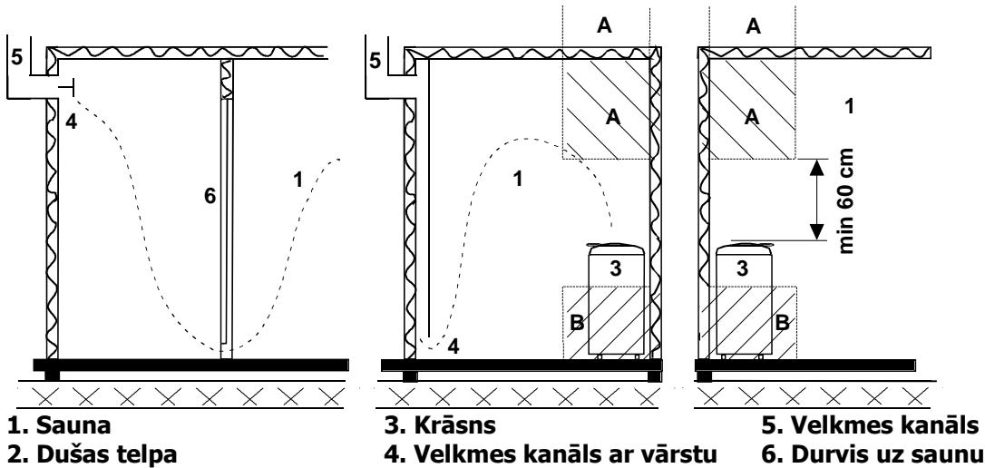
Saunā var ierīkot ventilatoru, kurš saunas sildīšanas un tās izmantošanas laikā atradīsies izslēgtā stāvoklī un kalpos saunas žāvēšanai pēc tās izmantošanas. Izmantojot pies piedu ventilāciju, ienākošā gaisa vārsts jānovieto A zonā.
