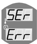
SEr Err (Serial Error) error de tráfico de serie entre el calentador y el controlador.
